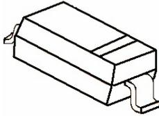
**SOD-323 贴片塑封肖特基二极管****SOD-323 Plastic-Encapsulate Schottky Barrier Diode****特征 Features**
